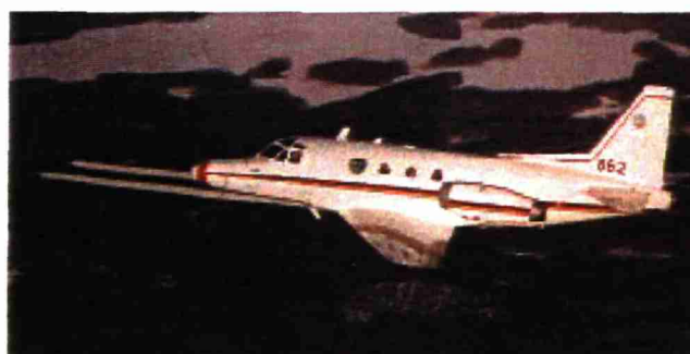
Figure 2 : Le capteur aéroporté CARABAS. Les deux antennes du capteur sont visibles à l'avant de l'appareil.
