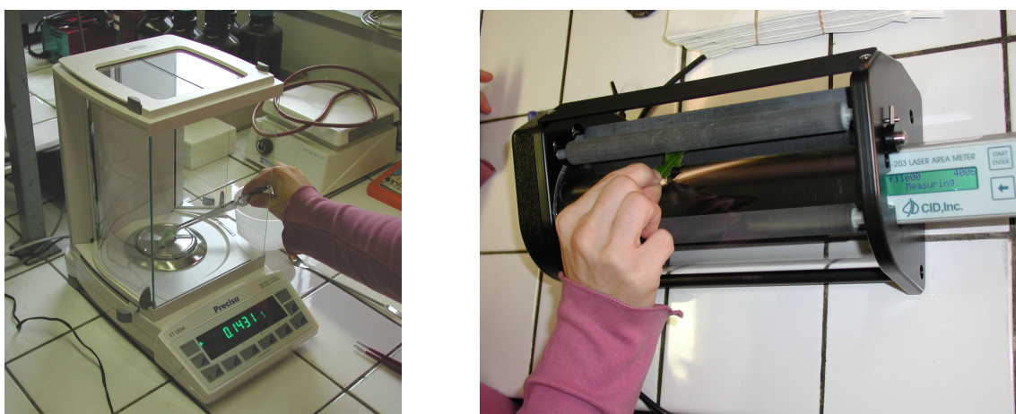
Figure 48. Balance électronique et planimètre laser
