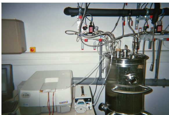
FIG. 5.4 – Montage du suivi en ligne par spectrométrie SPIR (JASCO-V570) de la fermentation alcoolique du vin blanc (échelle pilote - 100 L )
