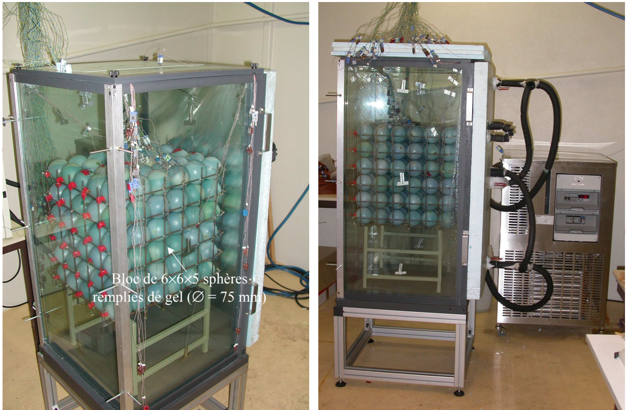
Figure A-16 : Dispositif expérimental pour la mesure de la température d'air et à cœur des produits - Maquette partiellement remplie de sphères en gel (empilement de 6x6x5 sphères en gel)
