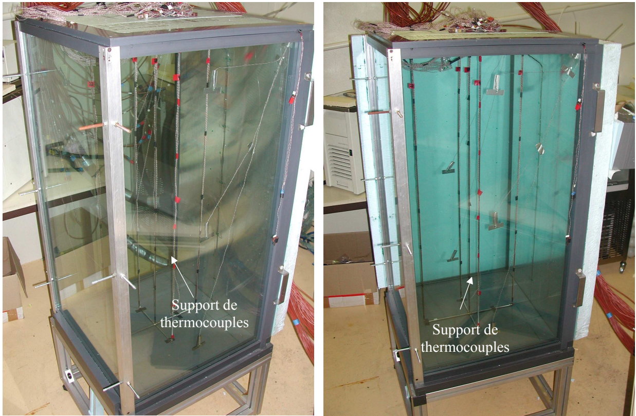
Figure A-14 : Dispositif expérimental pour la mesure de la température d'air dans la maquette vide
