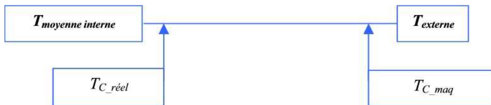
Figure A-4 : Positionnement de T_{C\_réel} et T_{C\_maq} par rapport à la température interne moyenne de l'air (dans la maquette ou le réfrigérateur) et la température externe
