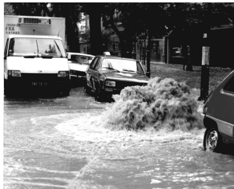
Figure I. 2 : débordement d'un réseau d'assainissement durant l'inondation du 3 octobre 1988 à Nîmes (provenance de (Bonneaud S., 2002))
