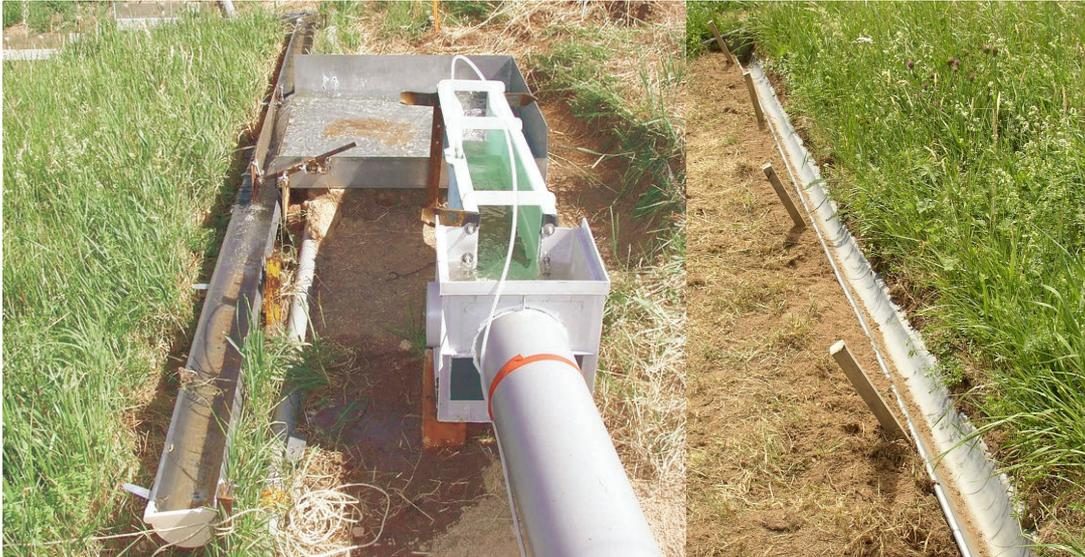
**Figure II.14 : Photographie du système d'amenée et de la déverse en fonctionnement (à gauche) et du système de récupération à l'aval (à droite).**
