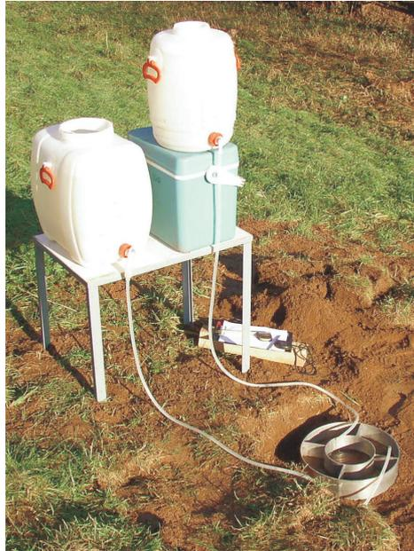
Figure II.31 : Photographie du système d'infiltrométrie Müntz.
