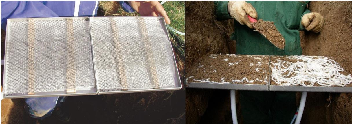
**Figure II.23 : Photographie des collecteurs installés à 50 cm de profondeur. Gauche : collecteurs fonctionnant à pression atmosphérique. Droite : collecteurs avec mèches en fibres de verre.**
