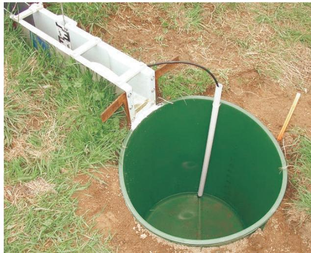
**Figure II.18 : Photographie du piège à ruissellement équipé d'un capteur de pression PDCR1830.**
