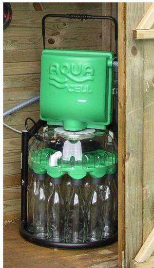
Figure II.19 : Photographie d'un préleveur d'échantillons.
