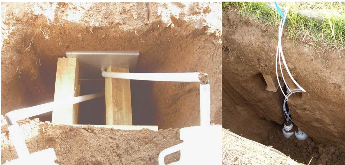
Figure II.25 : Photographie d'un lysimètre atmosphérique dans sa cavité (à gauche) et d'un lysimètre à mèche (à droite), avant rebouchage de la galerie et de la tranchée.
