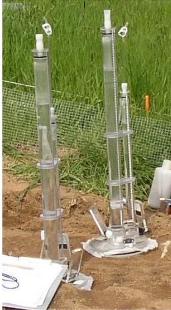
Figure II.32 : Photographie de deux infiltromètres à disque.
