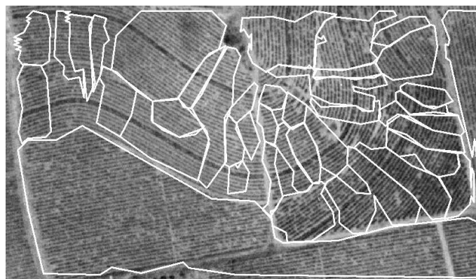
FIG. 3.26: Exemple de segmentation de parcelles de vignes dont les rangs suivent les courbes de niveau. Canal rouge d’une image aérienne à 0,5 m de résolution (Douro - Portugal).
