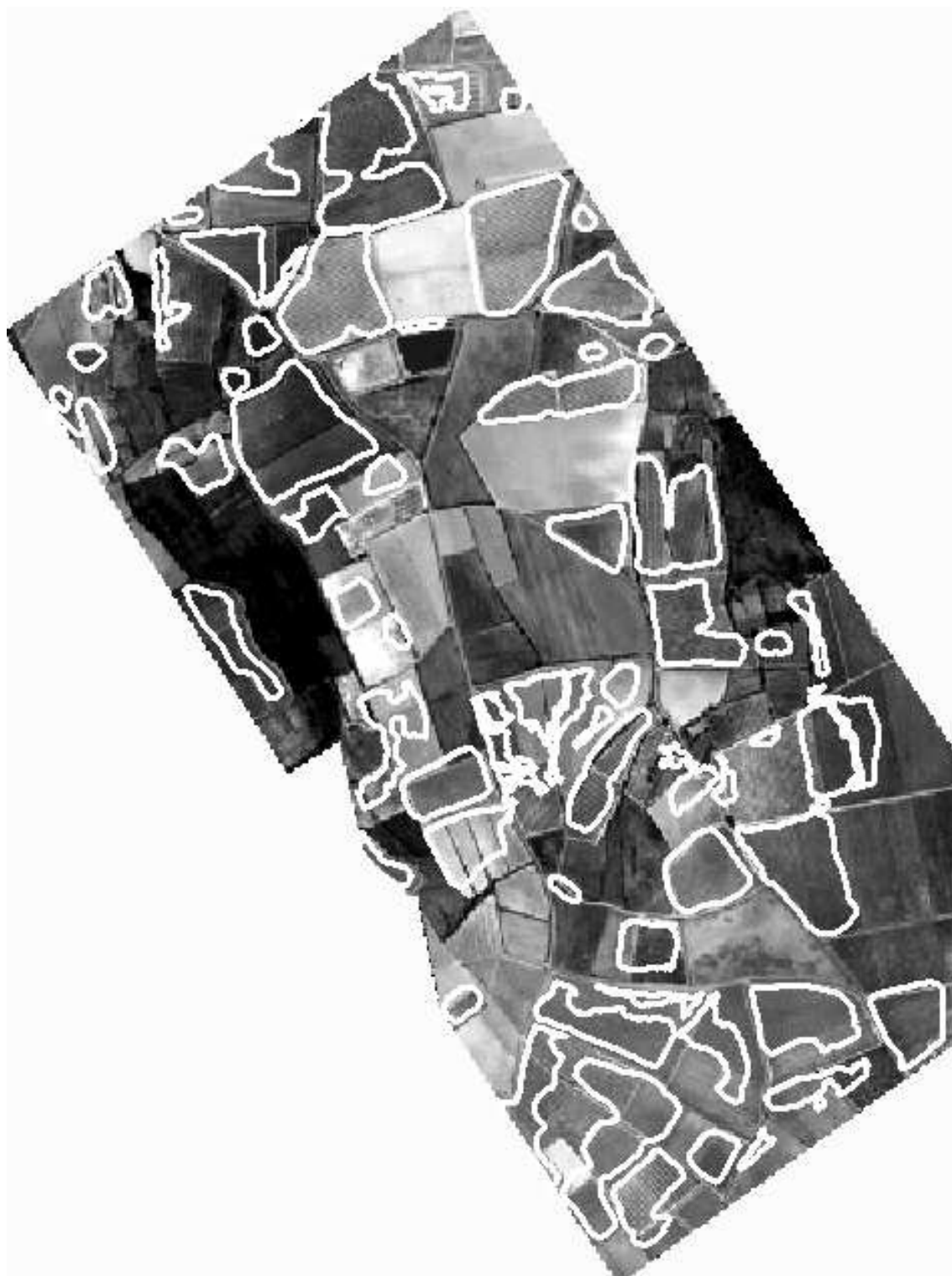
FIG. D.1: Résultats de segmentation par la méthode ICO. Image juin 2005 - canal rouge - résolution 0,5 m - taille fenêtre 30 m.
