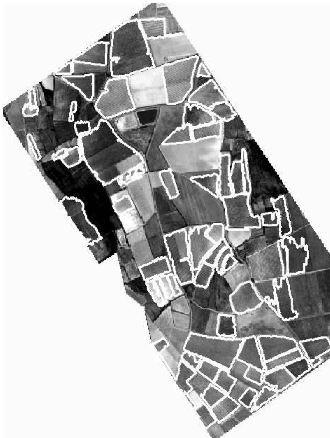
FIG. D.2: Résultats de segmentation par la méthode FGI. Image juin 2005 - canal rouge - résolution 0,5 m - taille fenêtre 30 m.
