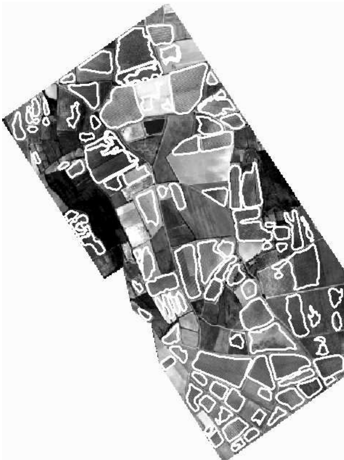
FIG. D.3: Résultats de segmentation par la méthode TFL. Image juin 2005 - canal rouge - résolution 0,5 m - taille fenêtre 30 m.
