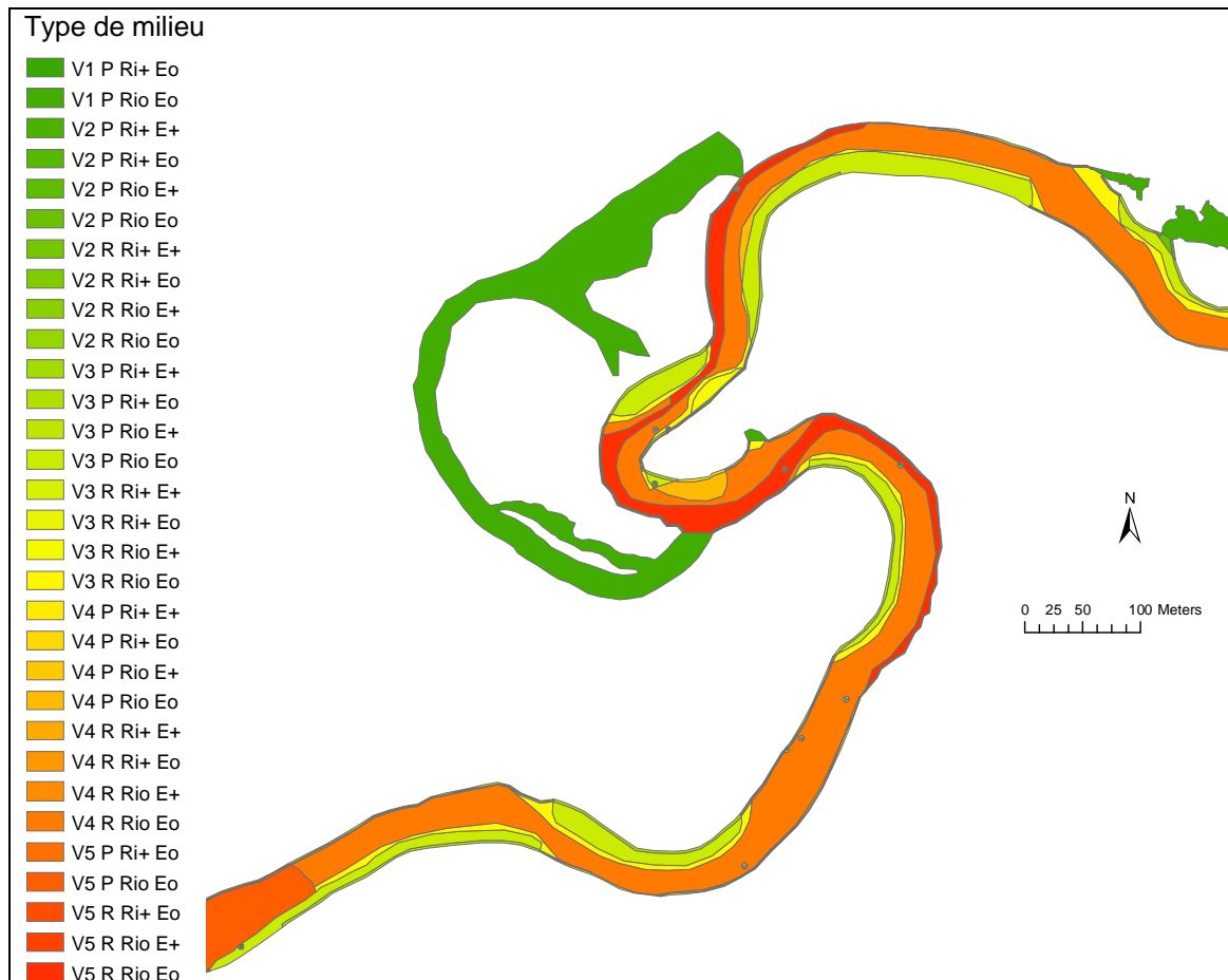
Figure 2.9 – Types de milieux présents dans un détail de la mosaïque des milieux pour le bief naturel à 70 m 3 /s. V1 à V5 : classe de vitesse du courant (voir Tableau 2.2) ; P : profondeur < 1 m ou R : profondeur > 1 m ; Ri+/Ri0 : présence/absence de ripisylve ; E+/E0 : présence/absence d'embâcle. Le substrat n'a pas été représenté par souci de clarté.
