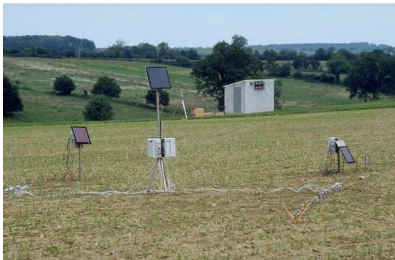
Figure 1.1 – Un exemple de capteurs sur une parcelle agricole expérimentale (Cemagref/J. M. Le-Bars)
