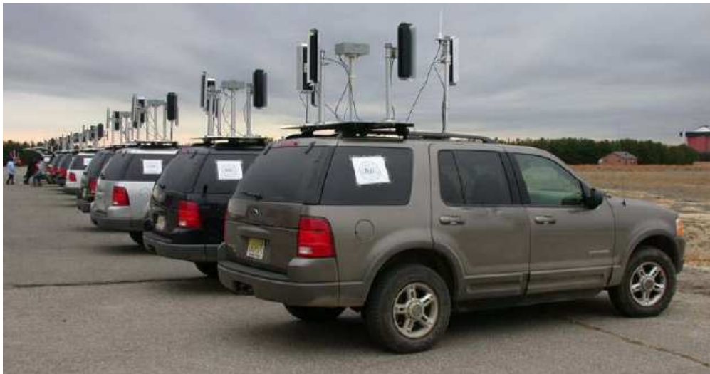
Figure 4.4 – Réseau de véhicules équipés d'antennes directives [Ramanathan 05]
