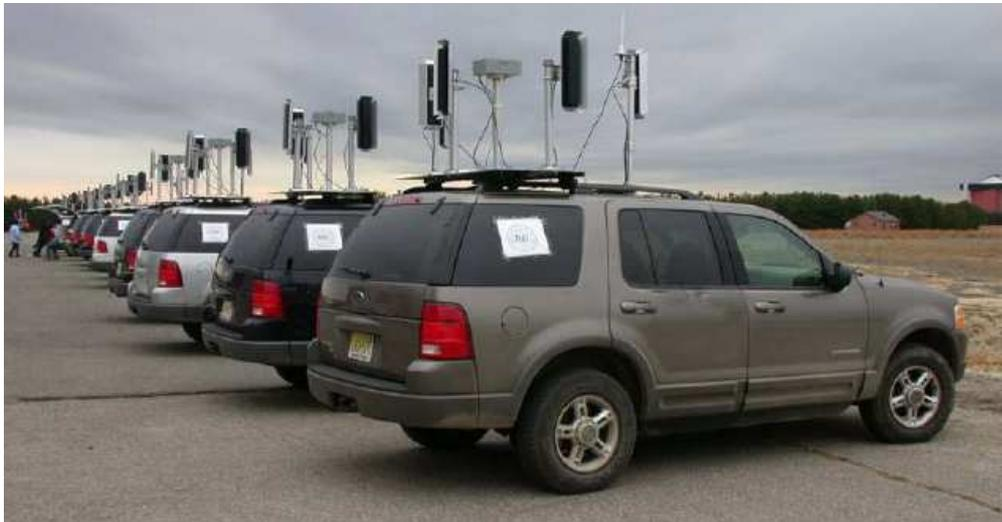
**Figure 4.4** – Réseau de véhicules équipés d'antennes directives [Ramanathan 05]
