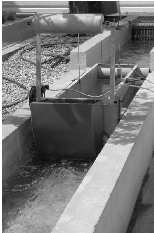
FIG. 2.8: Modèle réduit de vanne Vlugter installé dans le canal de l'ENSAM
