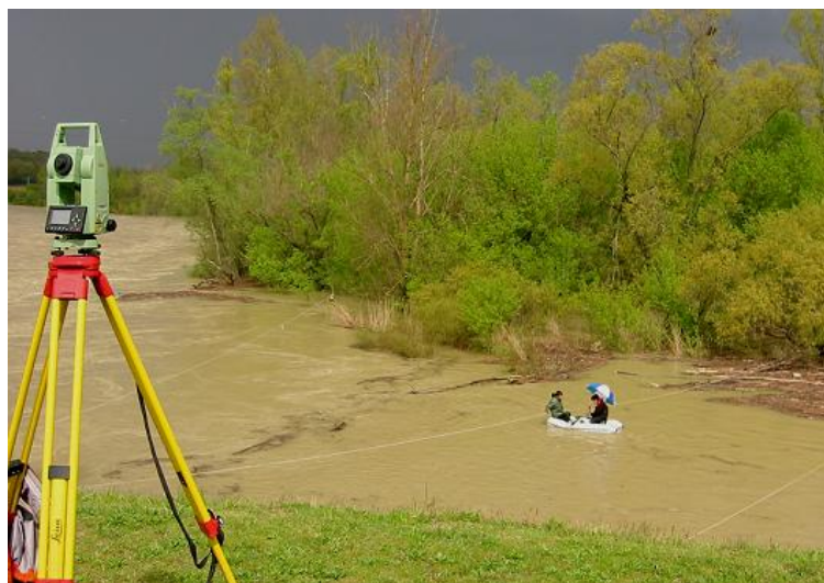
FIG. 2.10 – Mesures par aDcp dans la lône de Port-Galland pendant la crue du 25 avril 2005 L’Ain coule depuis le coin en haut à gauche de l’image ; les cordes blanches matérialisent les transects A, B et C (de gauche à droite)
