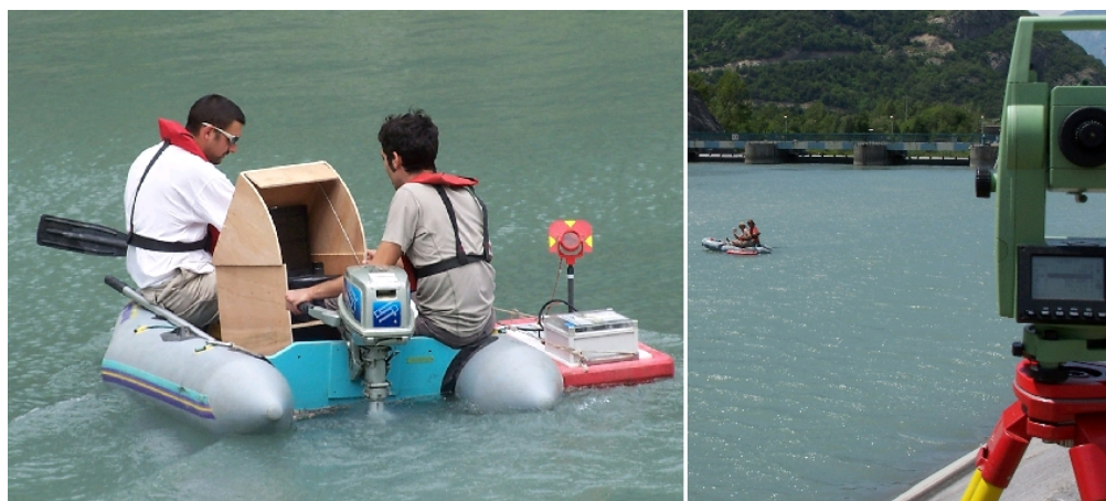
FIG. 3.17 – Mesure de la bathymétrie des retenues de Pont-des-Chèvres et Saint-Martin-la-Porte à l'aDcp avant et après la chasse de 2006. (a) Embarcation avec aDcp et acquisition embarquée
