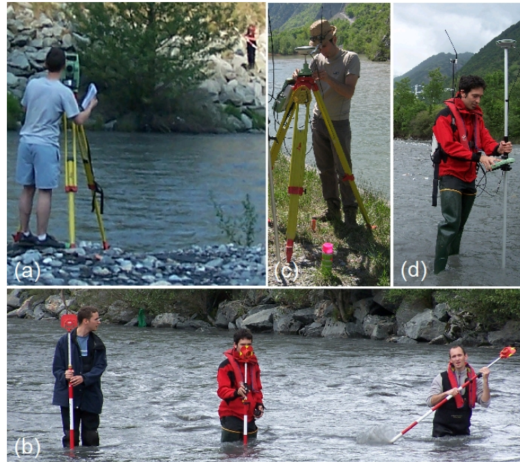
FIG. 3.1 – Déploiement pendant des campagnes topographiques (a) Station totale Leica TC305 et opérateur à la visée, (b) levé sur une section avec trois opérateurs munis de mires, (c) installation de la base dGPS (Leica system 1200), et (d) levé topographique avec le mobile dGPS du même système.
