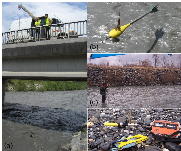
FIG. 4.5 – Jaugeages sur le site d'étude. A fort débit (a) par le camion jaugeur de la DIREN depuis le pont aval avec (b) un saumon plombé. (c) A faible débit sur une section en travers du site avec (d) un courantmètre électromagnétique. Photo©J. Lecoz, M. Lang.
