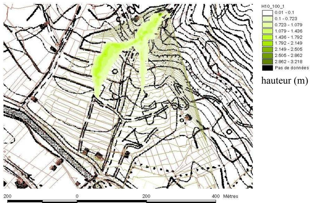
Figure 4.6 Hauteurs maximales simulées pour un volume de  $10\,000\text{ m}^3$ , un débit de pointe de  $100\text{ m}^3/\text{s}$  et un rapport  $\tau_c/\rho = 1,0\text{ m}^2/\text{s}^2$
