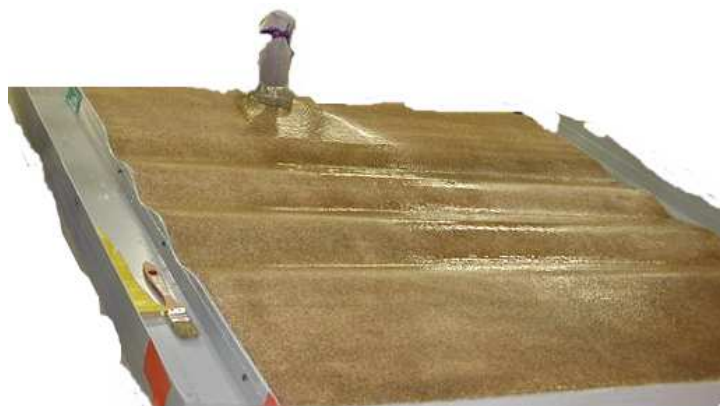
Figure 3: Écoulement sur une maquette de laboratoire avec une source d’eau ponctuelle (collaboration avec l’équipe de l’INRA d’Orléans).
