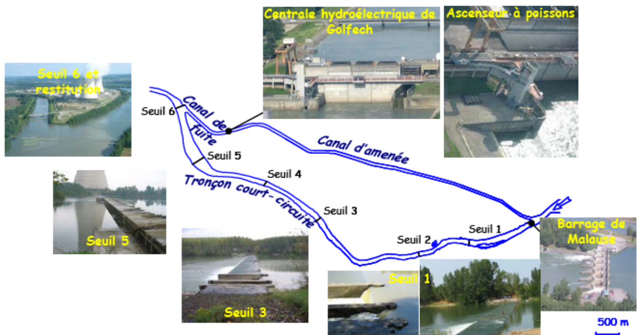
Figure 46 : Aménagement hydroélectrique de Golfech / Malause.
