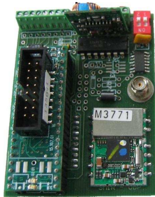
Figure 4.4 – Capteur sans fil LiveNode
