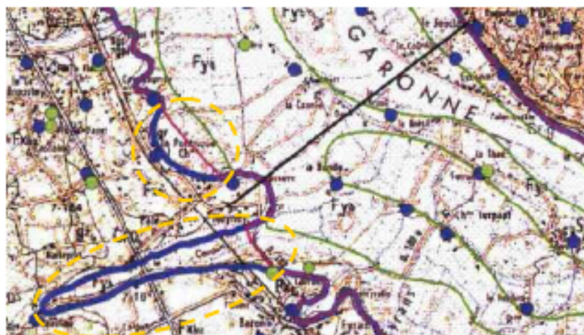
Figure 3.12 – Ajustement des limites de la NA de la Garonne entre Cadillac et Cadaujac grâce à la lithologie (Bichot, 1995) : limite de l'aquifère en bleu et de la NA en rouge.
