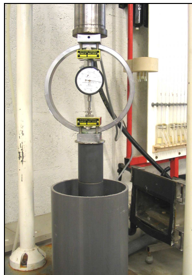
Essais mécaniques de résistivité des cellules en PVC avec application de la charge verticale pour compactage des déchets
