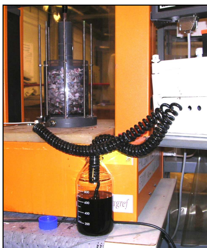
Injection de lixiviat avec la pompe
