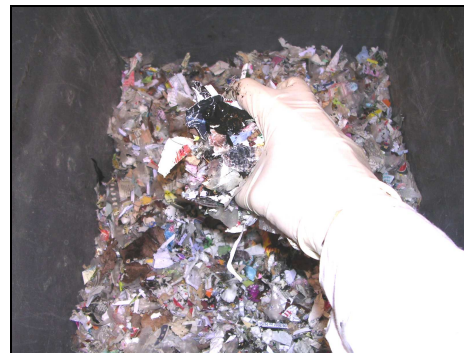
Inoculation des déchets avec le mélange de boue et de lixiviat
