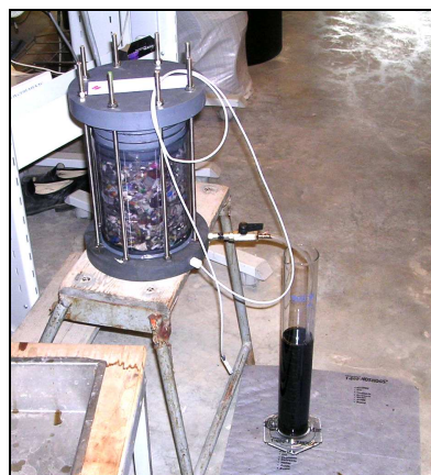
Drainage de lixiviat pendant un jour
