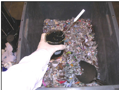
Inoculation des déchets avec le mélange de boue et de lixiviat
