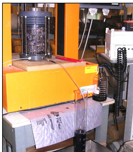
Application de la charge avec le couvercle
