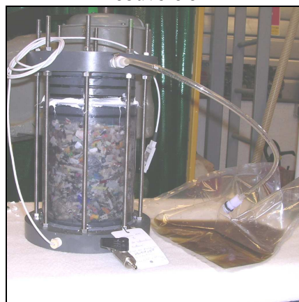
Lixiviat sorti dans la poche de biogaz à cause de la pression de biogaz
