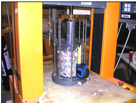
Remplissage des cellules et application de la charge verticale pour compacter les déchets
