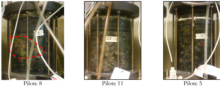
Figure (4-5) Zones dégradées et intactes dans les pilotes 8, 11 et 5
