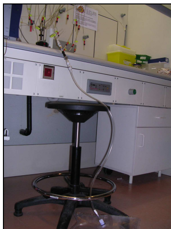
Figure (4-2) Connexion de la poche de biogaz au Micro-GC
