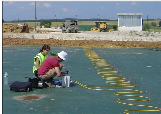
Installation des panneaux électriques sur le site pour mesurer la résistivité électrique
