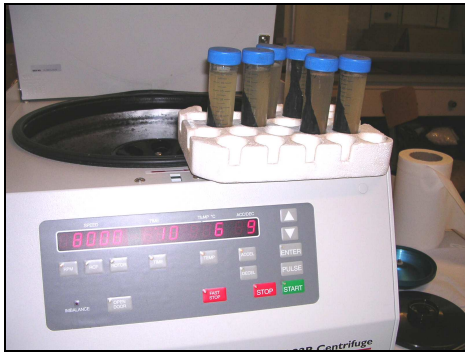
Centrifugation des boues liquides pour séparer l'eau de la partie solide, afin de ne pas trop modifier les caractéristiques du lixiviat utilisé pour saturer les déchets
