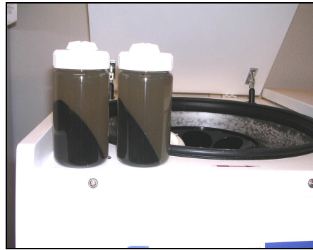
Centrifugation des boues liquides pour séparer l'eau de la partie solide, afin de ne pas trop modifier les caractéristiques du lixiviat utilisé pour saturer les déchets
