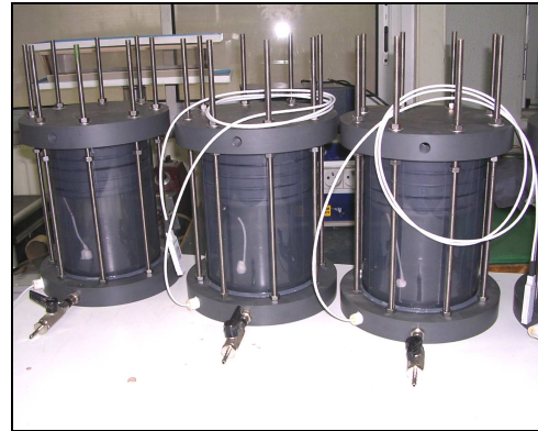
Préparation des cellules; installation des sondes de température dans les cellules et des joints isolants sur les couvercles
