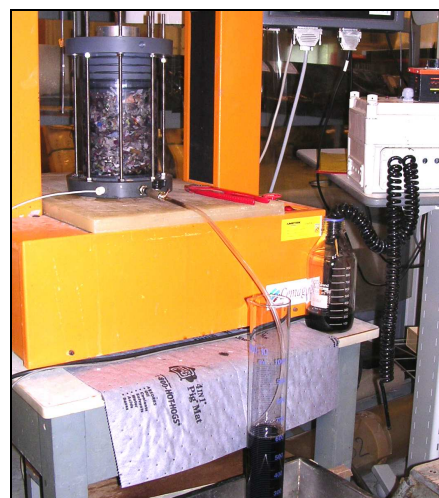
Application de la charge avec le couvercle
