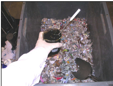
Inoculation des déchets avec le mélange de boue et de lixiviat
