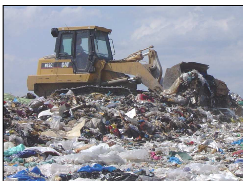
Stockage et compactage des déchets dans un pilote ouvert
