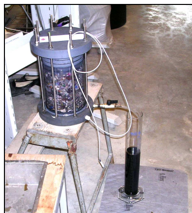
Drainage de lixiviat pendant un jour
