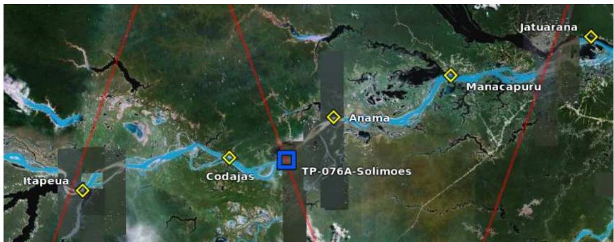
FIG. 5.5: Carte des stations limnimétriques utilisées pour reconstituer la série temporelle in-situ à la station virtuelle « TP-076A-Solimoes » à la figure 5.4 (Image GoogleEarth).
