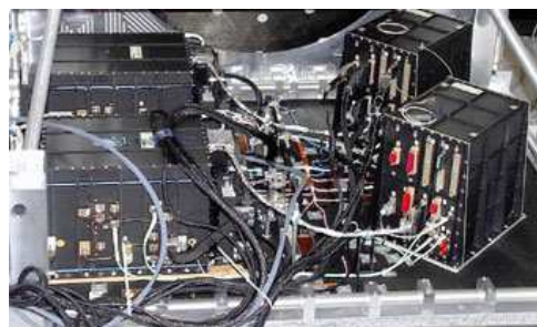
FIG. 1.9: L'altimètre Poseidon 2 qui équipe Jason-1. (Document CNES)
