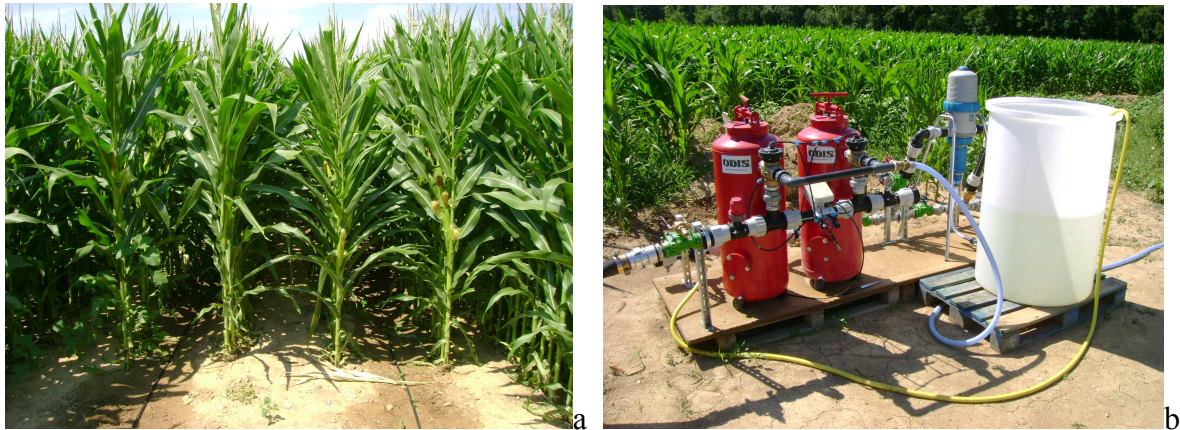
Fig. 5. (a) Positionnement des gaines goutte-à-goutte, (b) Station en tête du réseau d'irrigation utilisée au site expérimental de la station du Cemagref, domaine de Lavalette, Montpellier.
