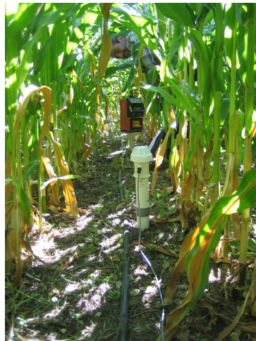
Fig. 7. Sonde à neutrons et la sonde capacitive EnviroSMART installées in situ.
