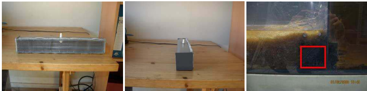
Figure C - 13 : Boîtes utilisées, constituées d'une paroi perméable, les autres étant imperméables. Une ouverture sur la partie supérieure permet l'aspiration et l'injection d'eau par la pompe péristaltique. Les boîtes sont placées en profondeur du rouleau à l'amont (photo de droite, écoulement de la droite vers la gauche) et à l'aval du canal.
