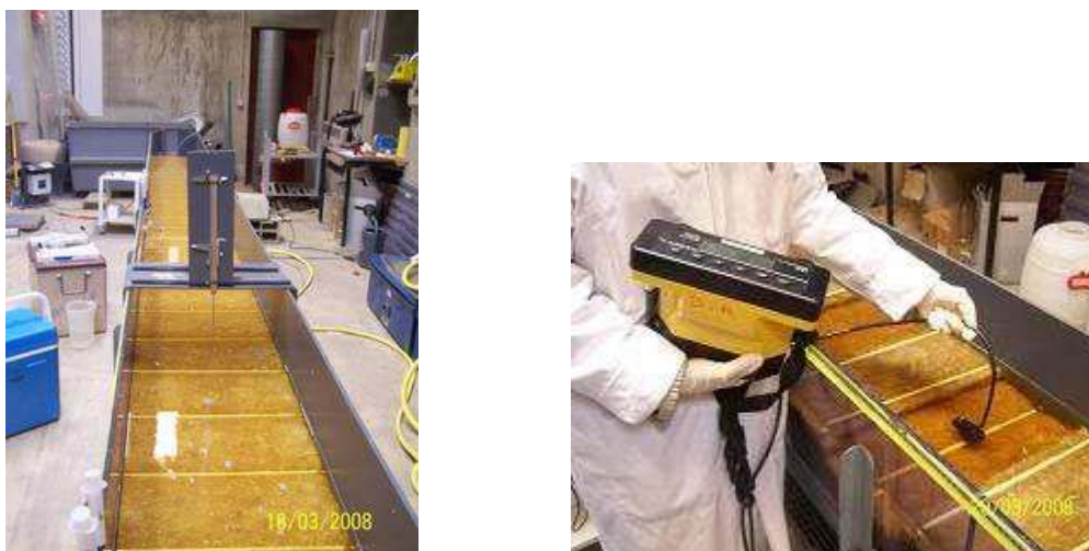
Figure C - 17 : A gauche : chariot utilisé pour la mesure de la hauteur d'eau. A droite : Mesure de la vitesse de l'écoulement de surface par courantométrie.
