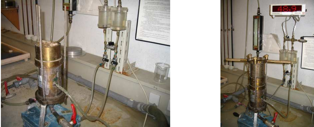
Figure B - 17 : Mesure de la conductivité hydraulique à saturation verticale K_v : photographies de l'expérimentation
