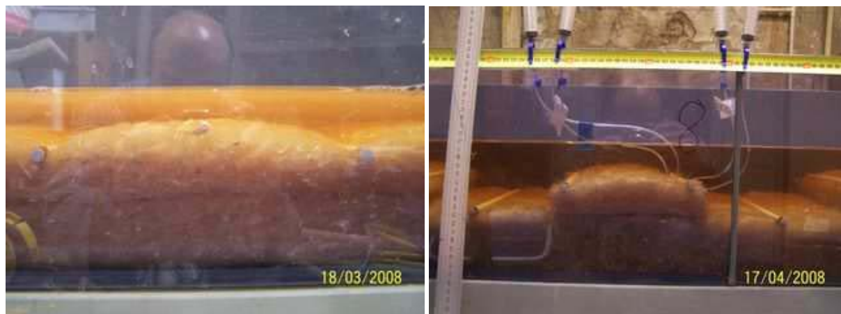
Figure C - 21 : Différences de formes pour les expérimentations avec longueurs d'ondes différentes. Image de gauche : forme en « dune » pour une longueur d'onde de 20 cm. Image de droite, forme en « créneau » pour une longueur d'onde de 40 cm.
