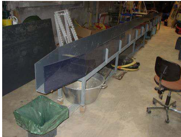
Figure C - 2 : Photographie du corps du canal expérimental
