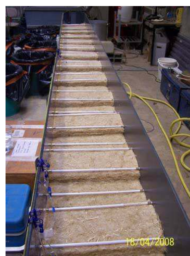
Figure C - 6 : Système de tringles utilisé pour pouvoir fixer les rouleaux de chanvre-polyester au fond du canal.
