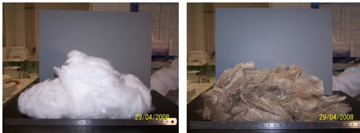
Figure B - 4 : Exemple de fibres de géotextiles utilisées. A gauche : fibres synthétiques de polyamide. A droite : fibres naturelles de chanvre.
