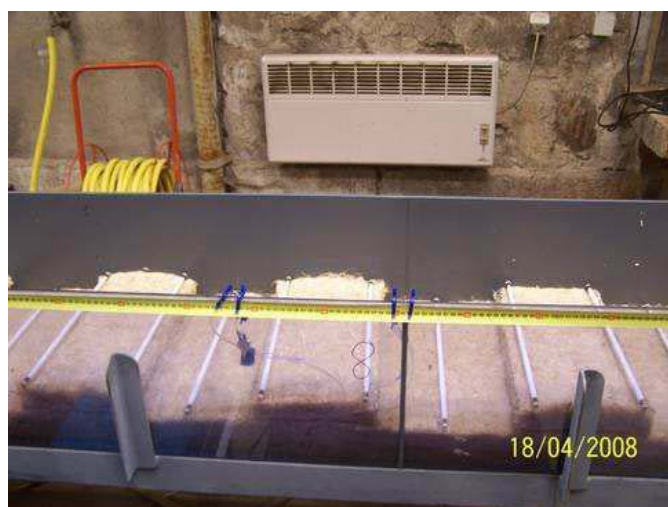
Figure C - 6 : Système de tringles utilisé pour pouvoir fixer les rouleaux de chanvre-polyester au fond du canal.
