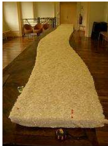
Figure B - 12 : Photographie du substrat retenu : rouleau d'un assemblage de fibres de chanvre et de polyester
