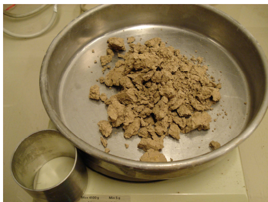
Figure A1-1 : Mesure de la teneur en eau, de la densité apparente et du poids de sol sec
