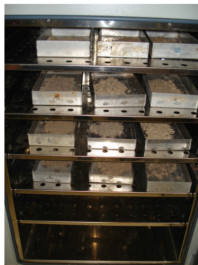
Figure A1-1 : Mesure de la teneur en eau, de la densité apparente et du poids de sol sec
