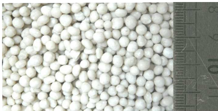
FIGURE 2.2 – Photographie d'un échantillon d'Ammonitrate 33.5% N ( \text{NH}_4\text{NO}_3 ) (Coopaca).
