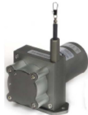
FIG. 1.24 – Potentiomètre linéaire filaire utilisé pour la mesure de l'angle de braquage.
