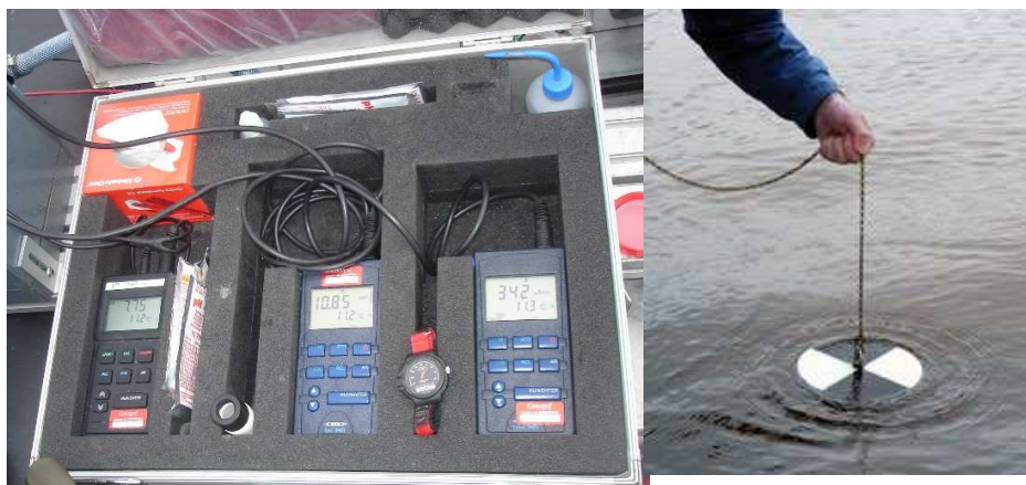
Figure 18. Sondes WTW et disque de Secchi.
