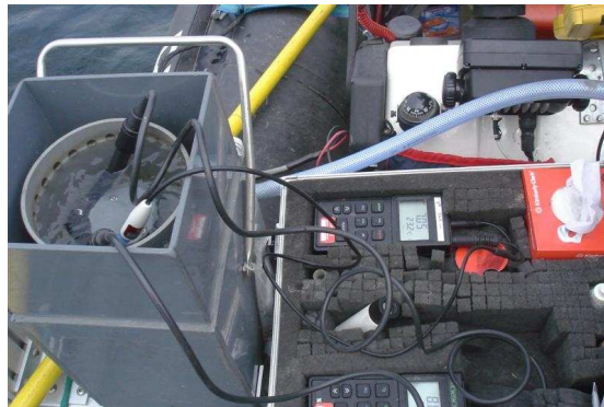
Figure 11. Pompe utilisée pour les prélèvements d'eau dans la zone profonde des lacs.
