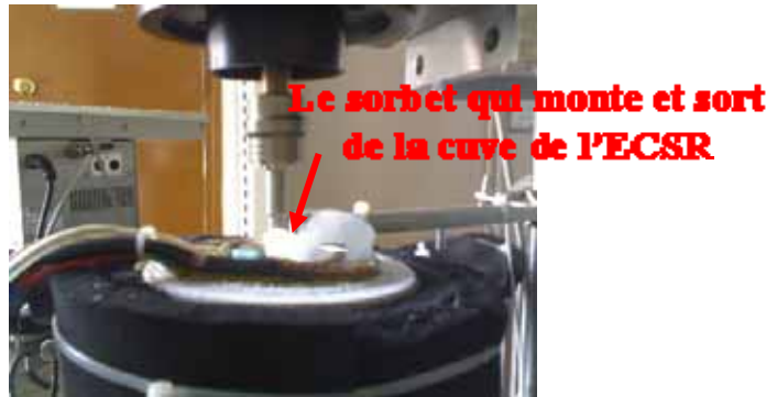
Figure III-5. Montée de la glace à l'extérieur de la cuve dans un essai de référence.
