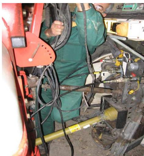
Figure 1.3: Vue partielle des liaisons tracteur-outils (arrière du tracteur à droite, outil à gauche)
