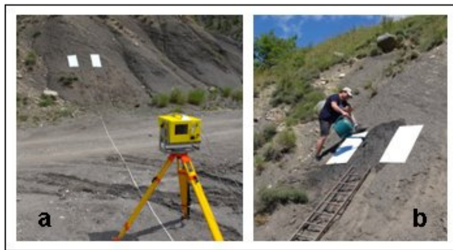
Figure IV.4 - Evaluation de l'effet du teneur en eau sur la performance du LiDAR terrestre.
