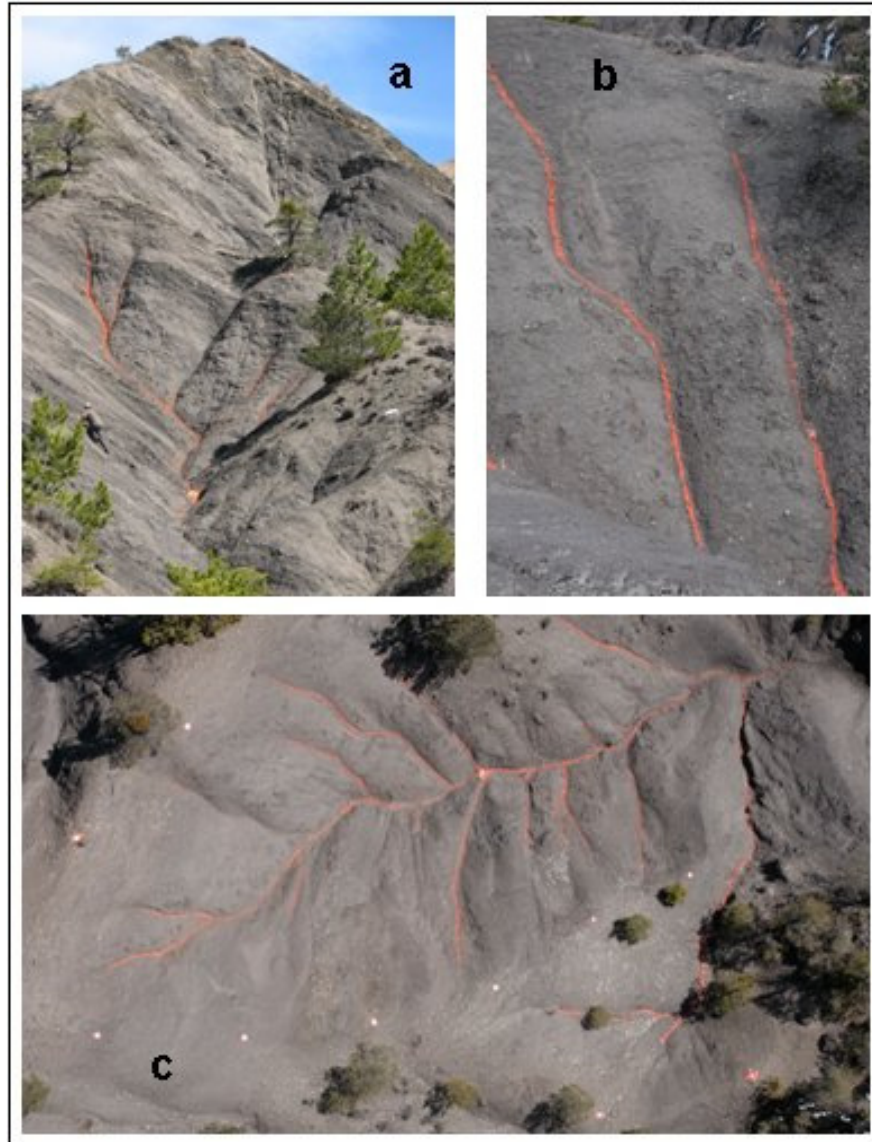
Figure III.39 - a) Ravine du Moulin, b) détail des rigoles avec peinture rouge avant le vol du drone avion, et c) photo aérienne drone avion-jaune mission 2008.
