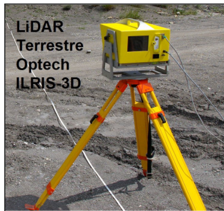
Figure IV.1 - LiDAR terrestre Optech ILRIS-3D, utilisé dans l'approche terrestre.
