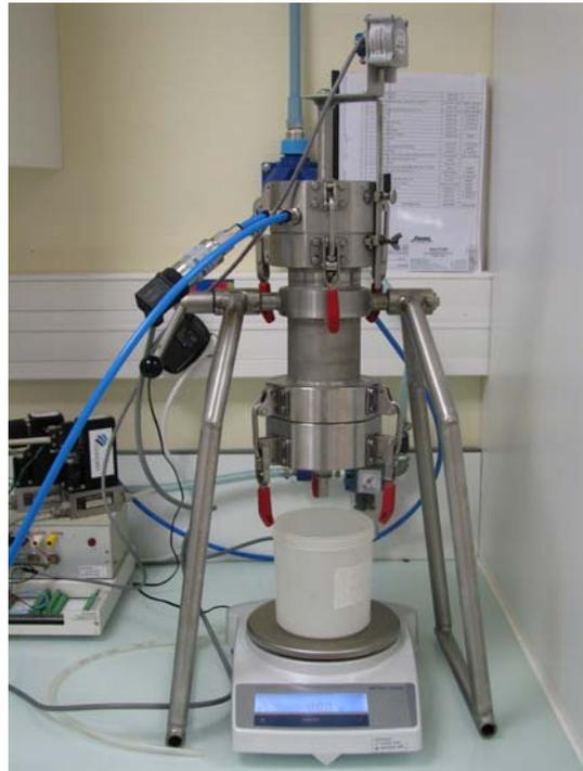
*Figure II. 13 : La Cellule de Filtration-Compression*
