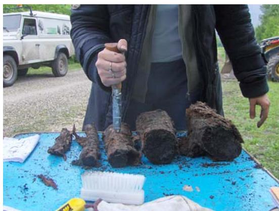
**Photo II.20 : Test de pénétrométrie au couteau sur les échantillons décomposés**
