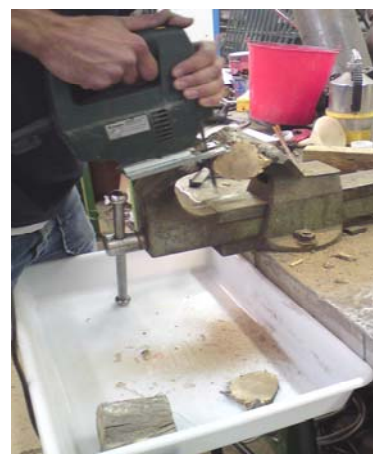
Photo II.23 : Découpe des échantillons en lamelles de 2 cm d'épaisseur
