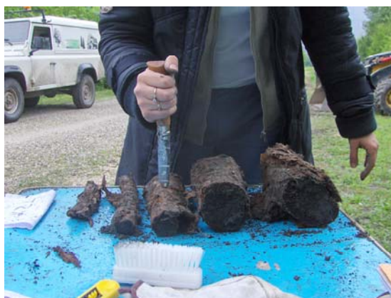
Photo II.20 : Test de pénétrométrie au couteau sur les échantillons décomposés
