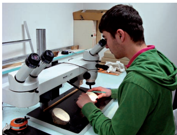
Figure 6 - Travaux au laboratoire : a) ponçage des échantillons ; b) lecture de cernes sous loupe binoculaire.
