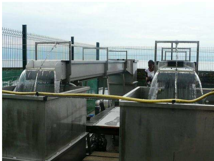
Figure 5 Mésocosmes extérieurs : 2 des 4 canaux, avec leur déversoir de sortie.
