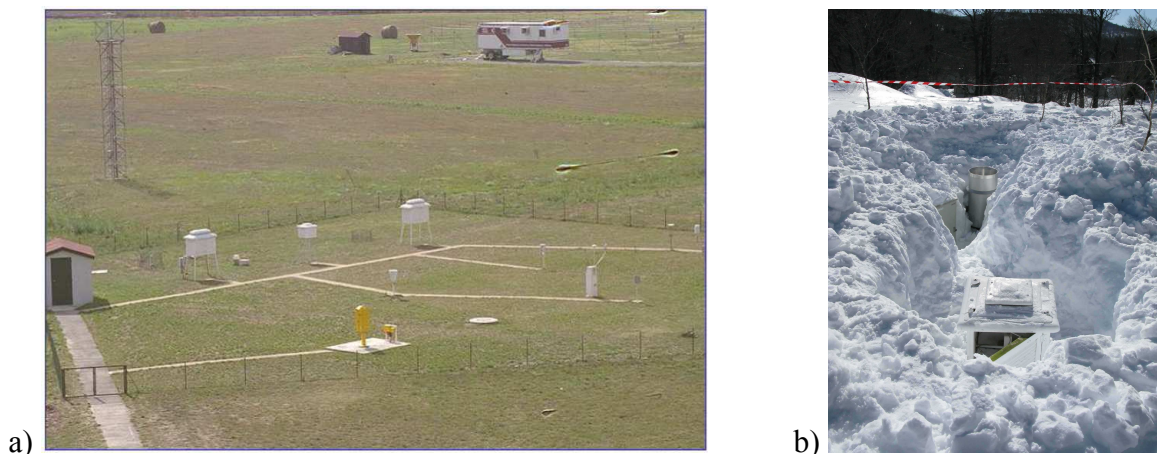
Figure 2-6 : Stations de mesure de la température de l'air a) parc d'instruments de mesure Météo France à Toulouse (source : Météo France) et b) stations du Mas de la Barque (source : EDF-DTG, CHA).
