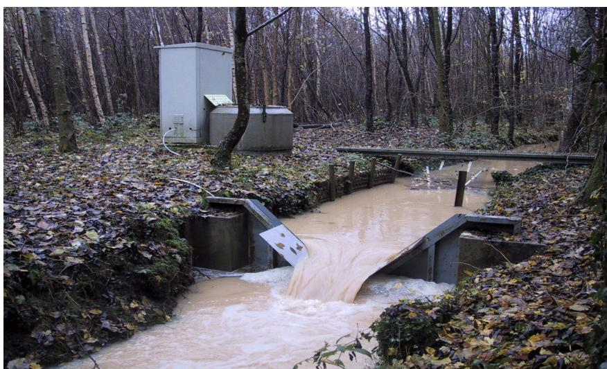
Figure I.7 : Station de mesures au fossé d'évacuation, exutoire du bassin versant de Goins (Ru de Choqueuse)
