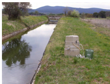
(d) Préleveur automatique sur la station de l'Avencq
