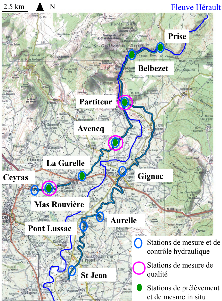
FIGURE 2.1 – Carte de du canal de Gignac, Hérault. Localisations des points de contrôle hydraulique et des stations de mesure
