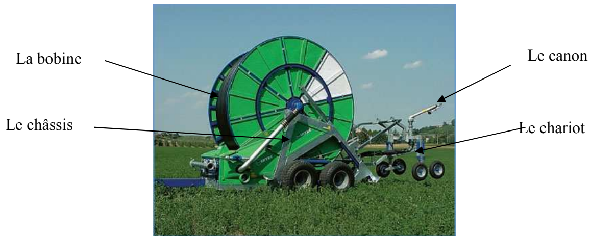
Figure I-4 : les différents composants de l'enrouleur
