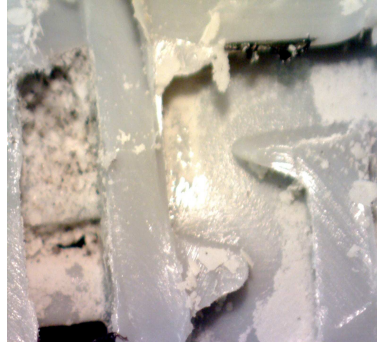
Figure IV-40 : Vue sous microscope de l'état du labyrinthe pour le cas 0.001M NaCl, sur les goutteurs colmatés (a) et non-colmaté (b)
