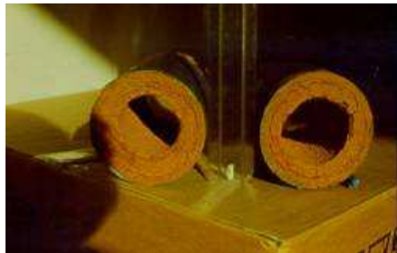
Figure I-18 : Colmatage ferrique des tubes par un biofilm développé par des bactéries sidérophores
