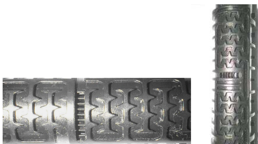
Figure II-4: Photo du goutteur GR et du labyrinthe utilisé pour étudier le colmatage en irrigation
