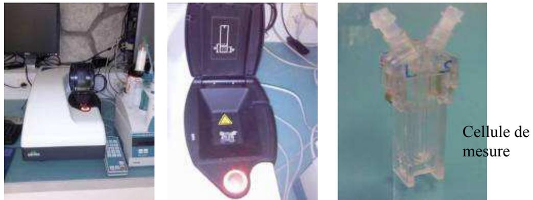
Figure IV-3: photo du Zetamètre et de la cellule de mesure
