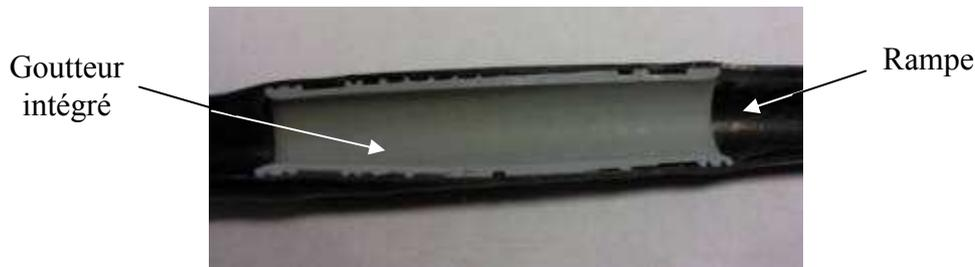
Figure I-12 : Coupe longitudinale d'un goutteur intégré dans la rampe
