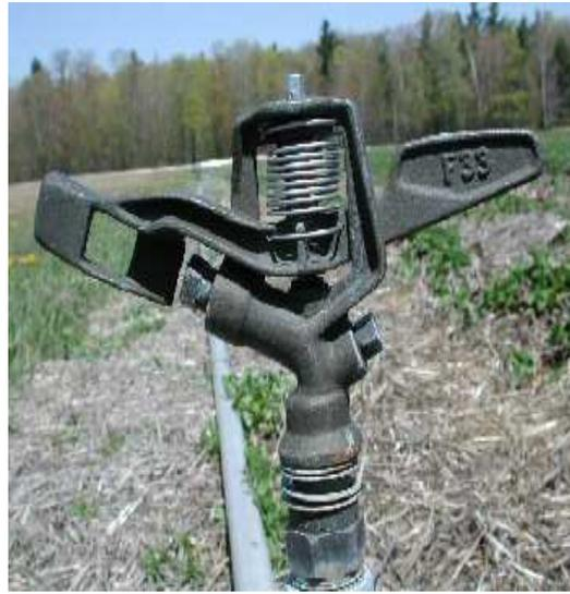
Figure I-3: Photo d'un asperseur
