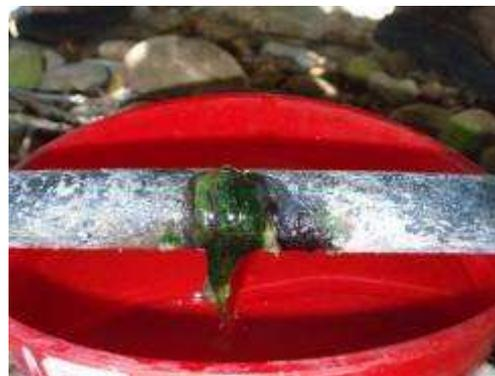
Figure I-17 : Obstruction par des algues de l'orifice de sortie d'un goutteur
