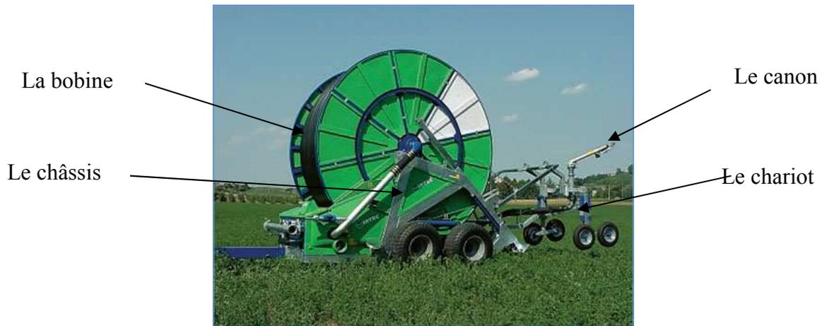
Figure I-4 : les différents composants de l'enrouleur
