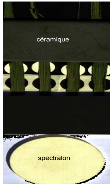
Figure A.9: Dispositif de l'expérimentation pour tester la procédure de correction en réflectance
