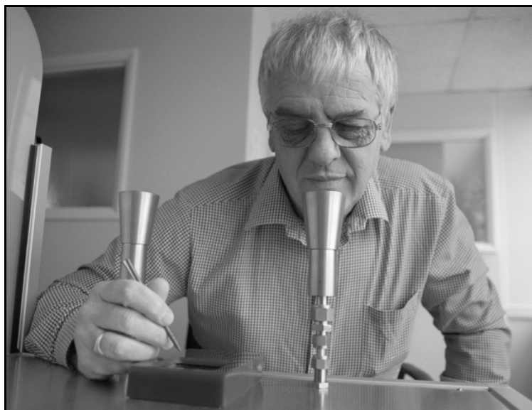
Figure 3 : la mesure d'une odeur s'appuie fondamentalement sur l'odorat. Cependant, le principe de la dilution jusqu'au seuil de détection fait en sorte qu'il est possible d'avoir une approche plutôt objective en créant un choix entre « oui » ou « non » pour savoir s'il y a présence ou non d'une odeur.
