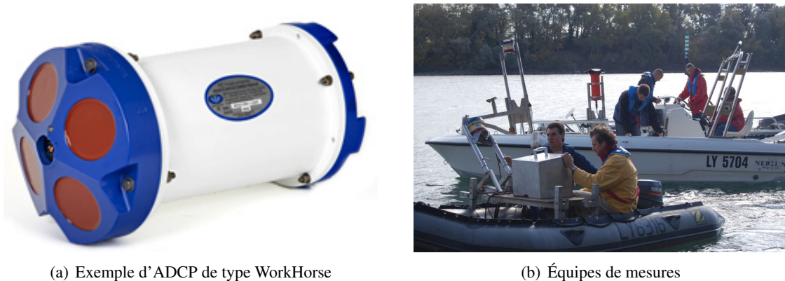
FIGURE 1.6 – Dispositif de mesure par ADCP (1.6(a)) et composition d'équipes de mesure (1.6(b)). Lors des mesures sur le Rhône le 30 octobre 2007, les bateaux ont embarqué un ADCP WorkHorse 1200 KHz (embarcation Zodiac en avant-plan), un WorkHorse 600 KHz (embarcation Neptune au centre) et un BroadBand 600 KHz (embarcation Aigoual à l'arrière).
