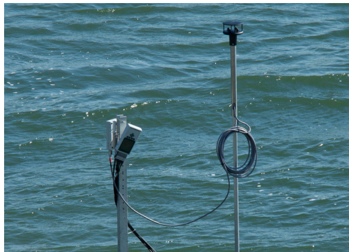
FIGURE 5.13 – Photo de l'anémomètre réalisée lors de la campagne de mesure sur le Rhône du 25 mai 2011
