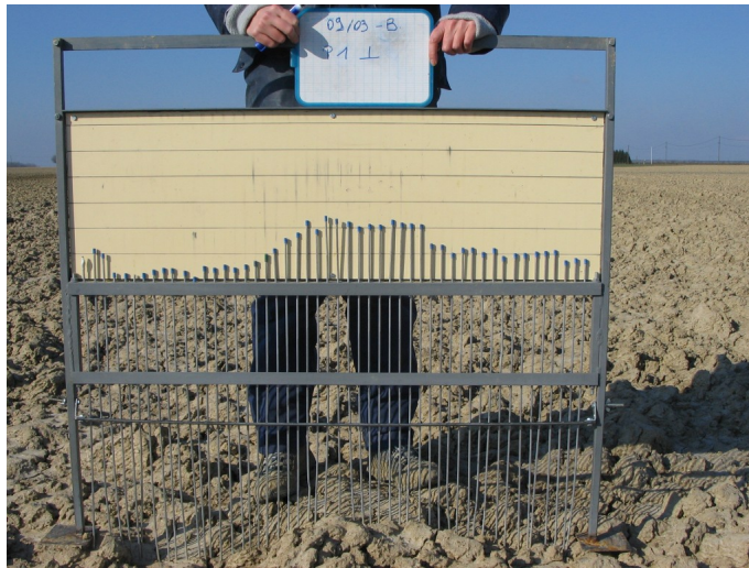
FIGURE 5.2 – Exemple de mesure de rugosité du sol avec un rugosimètre à aiguilles (Photo : Maëlle Aubert (Cemagref) pour une campagne de mesure de rugosité des labours sur le bassin de l'Orgeval)
