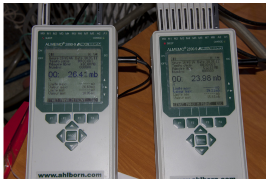
(b) Centrales d’acquisition Alhborn lors des mesures dans le bassin à vagues de l’IRPHE (celle de gauche enregistre à 400 Hz, celle de droite reçoit les signaux des 9 capteurs du châssis en L
