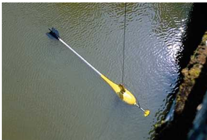
FIGURE 1.4 – Exemple de moulinet « saumon » pour la mesure de profil de vitesse ©Marc Sagot
