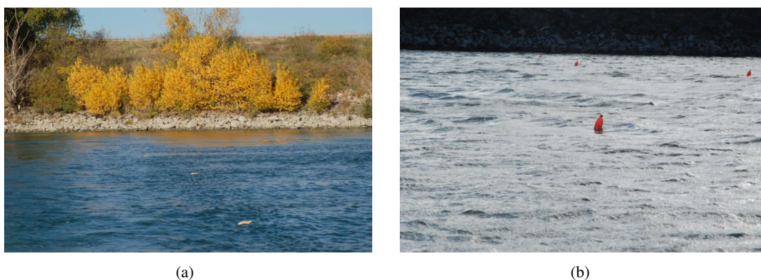
FIGURE A.1 – Photos des différents types de flotteurs utilisés pour les mesures par LSPIV : plaque de bois colorée de 10 cm x 15 cm à gauche, et bouteille à droite
