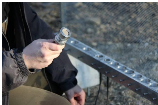
(a) Présentation d’un capteur de pression lors d’une campagne de mesure (Lez, le 22 janvier 2011), en arrière-plan la première barre de support des capteurs.
