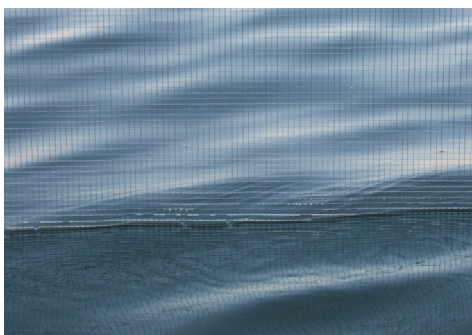
FIGURE 5.7 – Perturbations induites à la surface par une grille ( \varnothing_{fil} 0.66 mm) partiellement immergée
