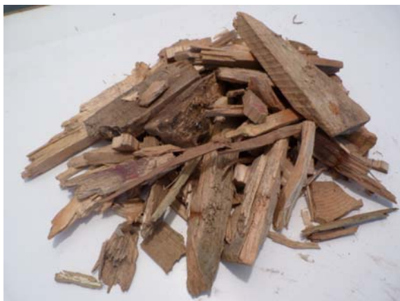
Figure 31 : palettes neuves broyées et criblées de granulométrie supérieure à 10mm
