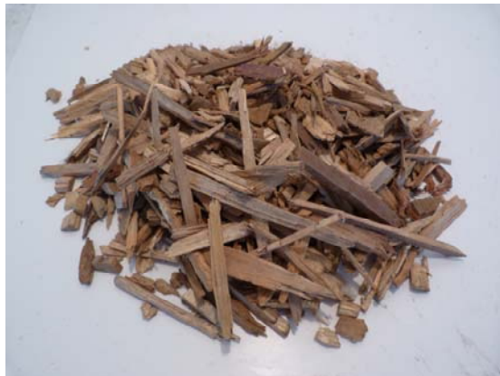
Figure 13 : palettes broyées et criblées fraction 10-20mm
