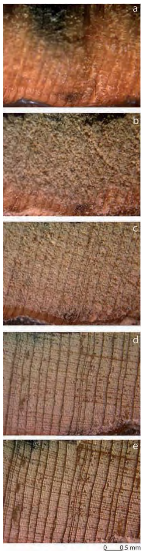
Figure 44. Evolution de la surface de l'échantillon après les différentes étapes de ponçage.
