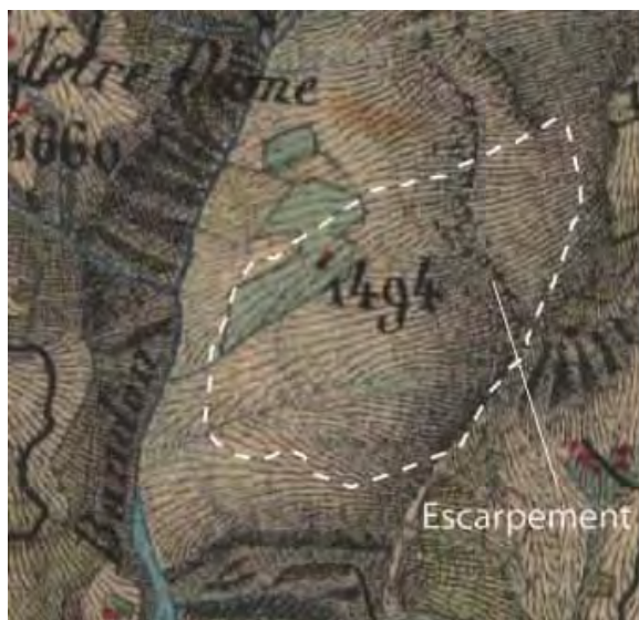
Figure 102. Glissement de terrain du Pra Bellon sur le fond topographique de l'État-Major (1825-1866).
