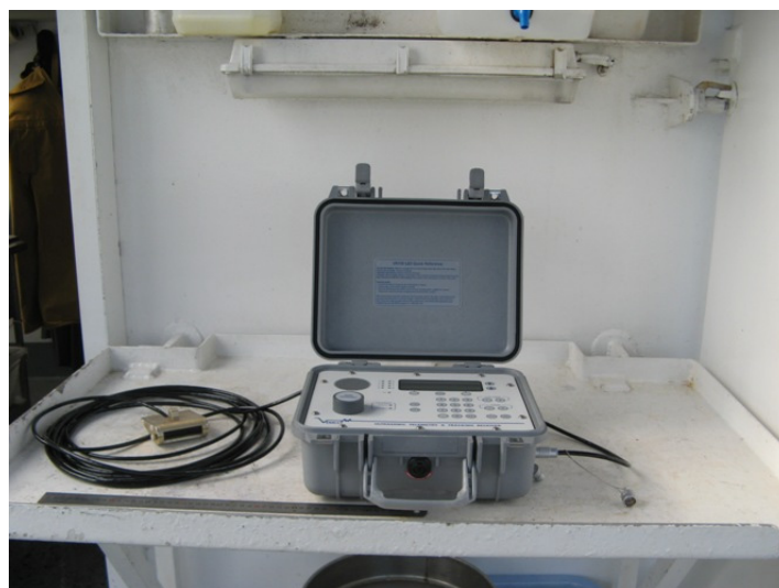
Figure 47 : Dispositif de réception VR100 (boîtier gris) couplé à un hydrophone directionnel (à gauche sur la photo)
