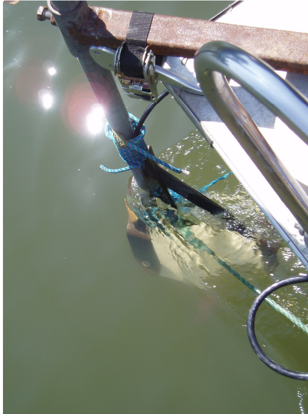
Figure 46 : Coque rigide (immergée) contenant les 4 hydrophones directionnels reliés au VR28
