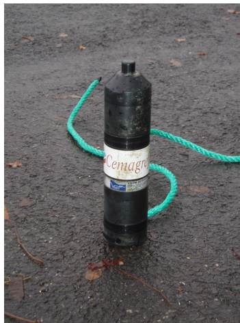
Figure 44 : Hydrophone autonome utilisé en poste fixe
