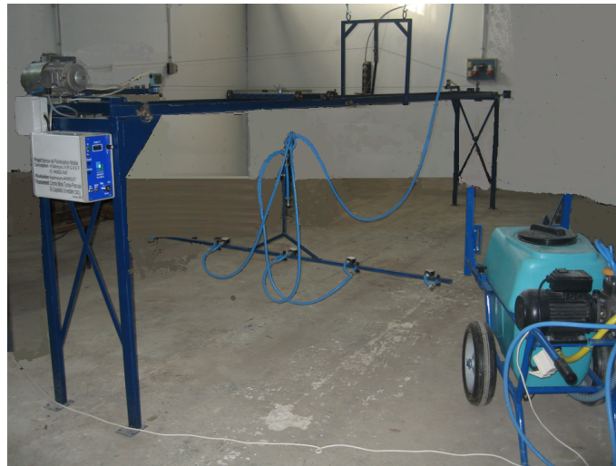
FIGURE 5.8 – Rampe mobile de pulvérisation pour mesurer les dépôts au sol et la rétention sur les plantes en conditions de laboratoire - INRGREF - Tunisie.
