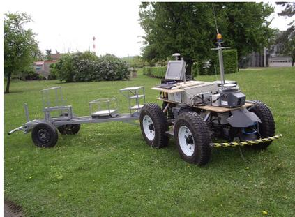
FIGURE 5.21 – Corps 0 et 1 du RMPA expérimental
