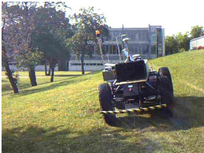
FIGURE 5.14 – Commande des deux trains directeurs du corps 0 du RMPA en pente
