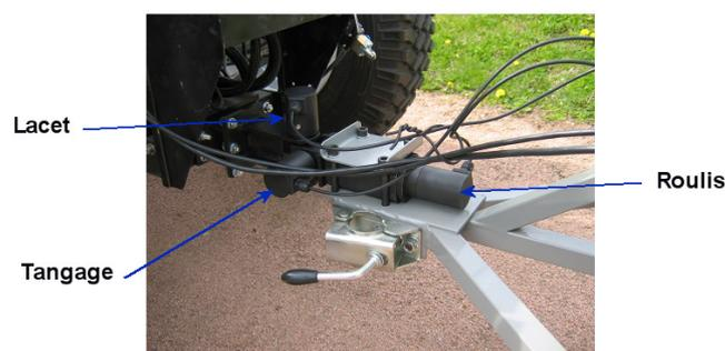
FIGURE 5.6 – Mesure des angles de brisure
