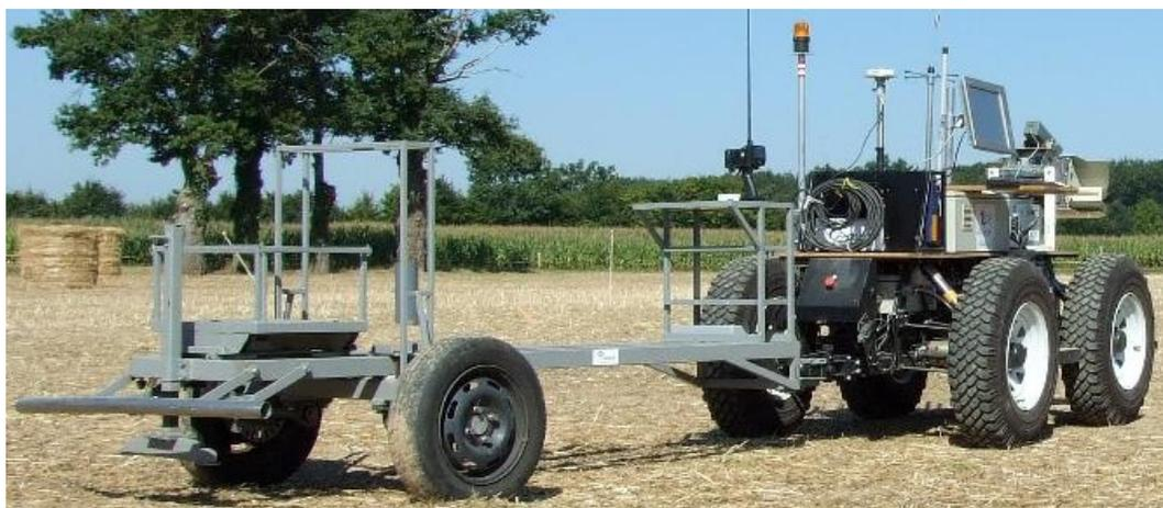
FIGURE 2 – RMPA expérimental : robot mobile tout terrain à deux trains directeurs associé à une remorque passive à attache déportée à un train roulant.
