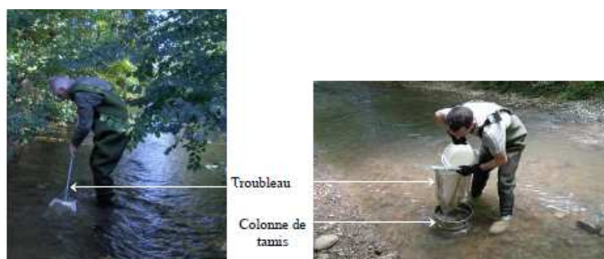
Figure II-13 : Prélèvement des organismes au troubleau et tri sur la colonne de tamis.
