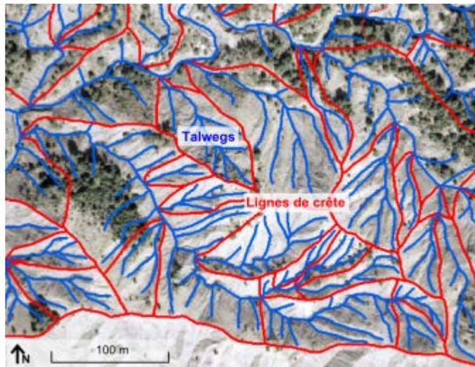
Figure 1.3. Les badlands, réseaux de ravines : réseaux de talwegs et de crêtes (Source : SIG Draix). Les seules lignes de crêtes représentées ici sont les limites des principaux sous bassins.
