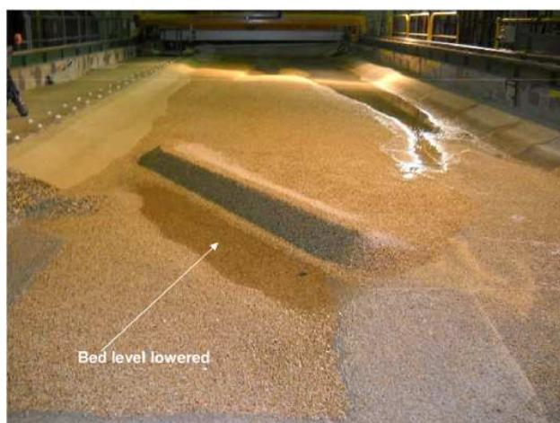
FIGURE 1.14 – Photographie du scénario 5 sur le site O2 qui consiste à enlever les protections de berge et abaisser la cote du fond en amont de l'épi (Source : Kamal El Kadi Abderrezak - EDF)
